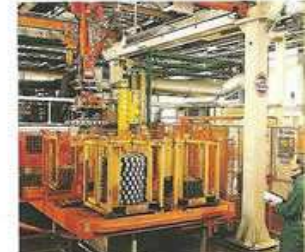
Estación Automática de tratamiento térmico
